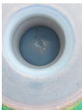
图 32-34 氮气手动阀及其球阀中心磨损情况
